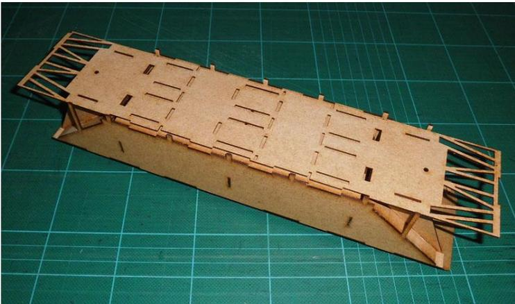
Auf die Dachplatte kommen die Stützleisten für das Oberdach geklebt, wobei diese Längsträger in die Aussparungen von der Deckplatte eingeklebt werden.
