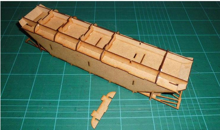
Entlang dem Rahmen werden die Innen Längsträgern eingeklebt.
