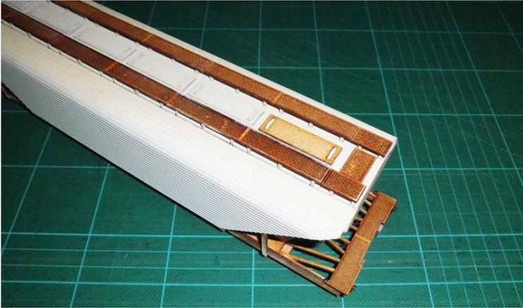
Nachdem der Verriegelung Mechanismus für jedes Schleuser montiert ist, wird der MDF Rohbau gespachtelt.
