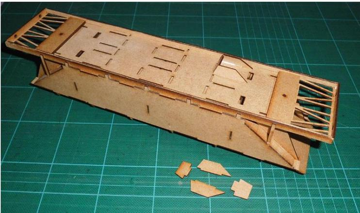
Auf jede Entleerungsschleuse wird eine Bodenplatte geklebt.
