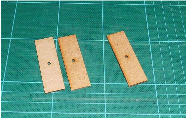
Die Drehgestell Stützen werden auf die Bodenplatte geklebt.
