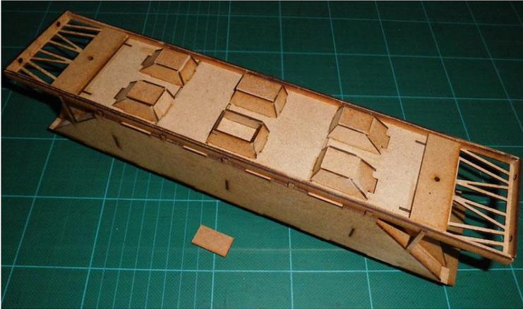
Entlang dem Rahmen werden die Innen Längsträgern gedoppelt und der Wagenkasten beklebt mit einer gesickten PE Platte die mit Holzklotzen eingespannt wird.
