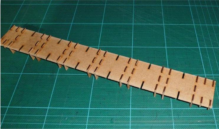
Die Dachplatte wird über die Querspannen geschoben und festgeklebt.
